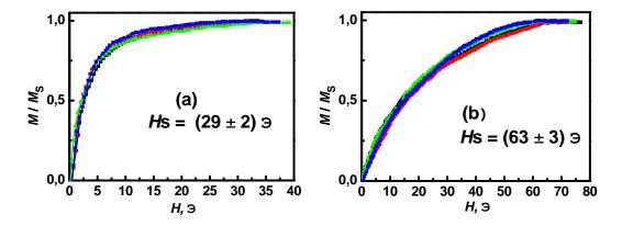
Рис. 3.6. Типичные приповерхностные локальные кривые намагничивания, наблюдаемые свободной (a) и контактной (b) сторон  $Fe_{73}(CuNbSiB)_{27}$  аморфной ленты на магнитооптическом магнетометре при регистрации магнитооптического сигнала с участка поверхности диаметром 200 мкм в магнитном поле, приложенном параллельно длине ленты.
