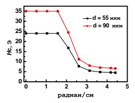
315... Зависимость коэрцитивной силы Нс от закручивающих напряжений, наблюдаемая для микропроводов диаметром 90 и 55 мкм.
