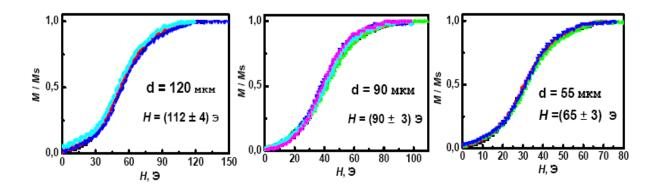
3.8. Типичные приповерхностные локальные кривые намагничивания, наблюдаемые для  $Fe_{73}(CuNbSiB)_{27}$  микропроводов на магнитооптическом магнетометре при регистрации магнитооптического сигнала с участка поверхности площадью (1x0.01) мм² в магнитном поле, приложенном параллельно длине микропровода.
