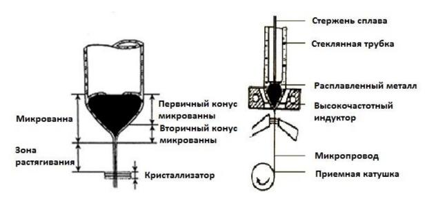
Рис. 1.3. Капельный метод получения металлического микропровода в стеклянной оболочке из жидкой фазы металлов по методу проф. А. Улитовского (а) и «непрерывный» метод литья микропровода, предложенный в ИМЕТ РАН (б).
