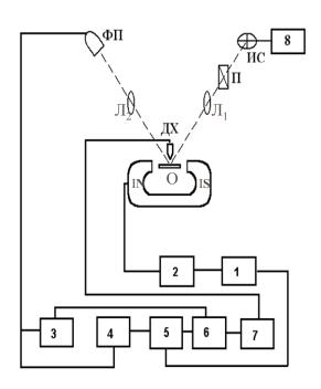
Рис. 2.1. Блок-схема магнитооптической установки, собранной на базе микроскопа МИС-11.
