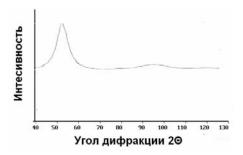
Рис. 3.1. Типичные результаты рентгеноструктурного анализа изучаемых микропроводов.
