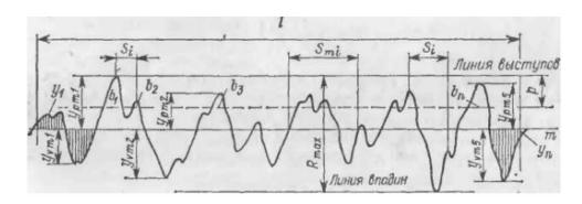
Для оценки шероховатости поверхности наиболее часто используют высотные параметры:  $R_z$  и  $R_a$ .  $R_z$  — высота неровностей профиля по десяти точкам; представляет сумму средних абсолютных значений высот пяти наибольших выступов профиля и глубин пяти наибольших впадин профиля в пределах базовой длины l:
