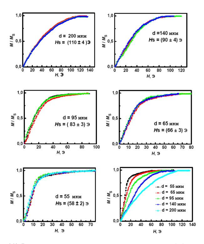
3.10. Типичные приповерхностные локальные кривые намагничивания, наблюдаемые для  $Fe_{43}Co_{29}Ni_6(SiB)_{22}$  микропроводов на магнитооптическом магнетометре при регистрации магнитооптического сигнала с участка поверхности площадью (1x0.01) мм² в магнитном поле, приложенном параллельно длине микропровода.
