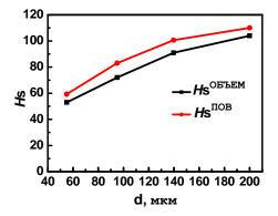
3.14. Зависимости приповерхностных и объемных значений поля насыщения  $Fe_{43}Co_{29}(NiSiB)_{28}$  микропроводов от их диаметра.
