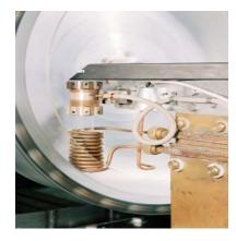
Рис.1.2. Вид лабораторной установки ИМЕТ РАН по получению провода с помощью первого метода.
