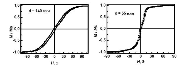
3.11. Типичные приповерхностные петли гистерезиса, наблюдаемые для  $Fe_{43}Co_{29}(NiSiB)_{28}$  микропроводов на магнитооптическом магнетометре в магнитном поле, приложенном параллельно длине микропровода.
