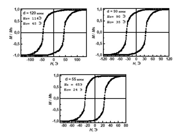
3.9. Типичные приповерхностные петли гистерезиса, наблюдаемые для  $Fe_{73}(CuNbSiB)_{27}$  микропроводов на магнитооптическом магнетометре при регистрации магнитооптического сигнала с участка поверхности площадью (1x0.01) мм<sup>2</sup> в магнитном поле, приложенном параллельно длине микропровода.
