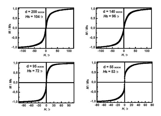
3.13. Объемные петли гистерезиса, наблюдаемые для  $Fe_{43}Co_{29}(NiSiB)_{28}$  микропроводов в магнитном поле, приложенном параллельно длине микропровода.
