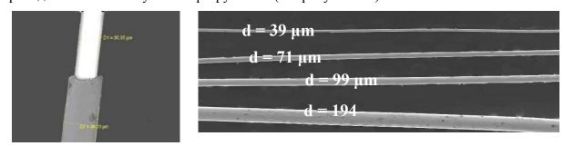
Рис. 3.2. Вид «толстых» железо-обогащенных аморфных микропроводов различных диаметров, полученных с помощью модернизированного метода Улитовского-Тейлора (справа) и вид микропровода с частично удаленной стеклянной оболочкой (слева).
