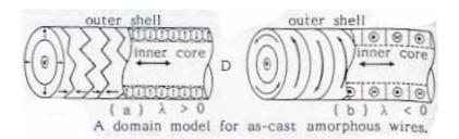
Рис.1.1. Схематическое изображение доменной структуры, предложенной для проволок с положительным (а) и отрицательным (b) значением магнитострикции.
