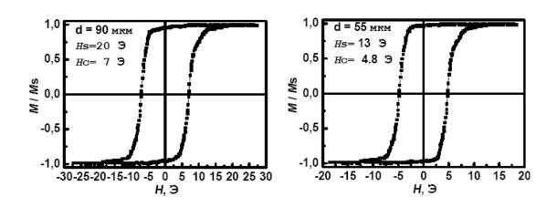
3.16. Петли гистерезиса, наблюдаемые для  $Fe_{73}(CuNbSiB)_{27}$  микропроводов при наличии закручивающего напряжения, равного 3.7 радиан/см.
