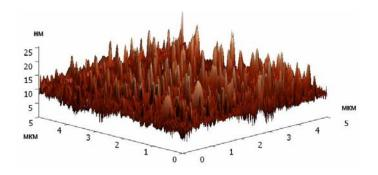
Рис. 3.5. Типичное ACM изображения поверхности, наблюдаемое для изучаемых микропроводов.
