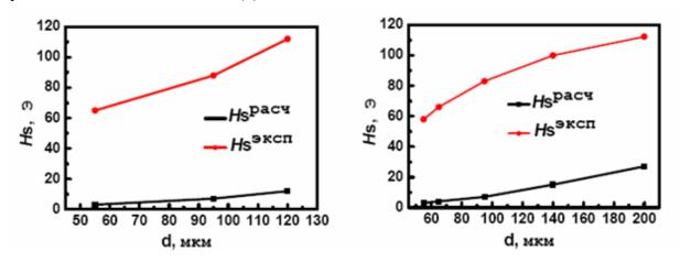
3.12. Рассчитанные и экспериментально найденные значения поля насыщения  $Fe_{73}(CuNbSiB)_{27}$  (слева) и  $Fe_{43}Co_{29}Ni_6(SiB)_{22}$  микропроводов (справа).
