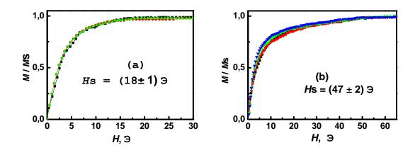
3.7. Типичные приповерхностные локальные кривые намагничивания, наблюдаемые для свободной (a) и контактной (b) сторон  $Fe_{43}Co_{29}(NiSiB)_{28}$  аморфной ленты на магнитооптическом магнетометре при регистрации магнитооптического сигнала с участка поверхности диаметром 200 мкм в магнитном поле, приложенном параллельно длине ленты.
