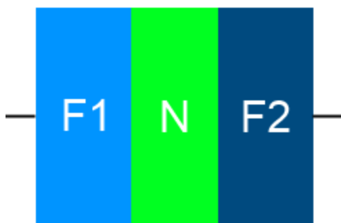
Рис. 3. Спиновый сэндвич. F1 – это ферромагнетик с большой коэрцитивной силой, а F2 — с маленькой коэрцитивной силой, N— немагнитное вещество.
