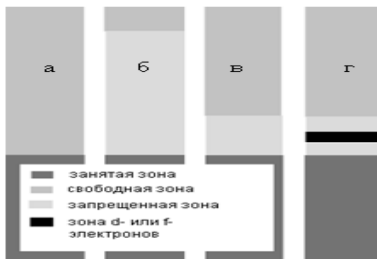
Рисунок 1.1. Зонная структура а) проводников, б) диэлектриков, в) полупроводников, г) разбавленных магнитных полупроводников
