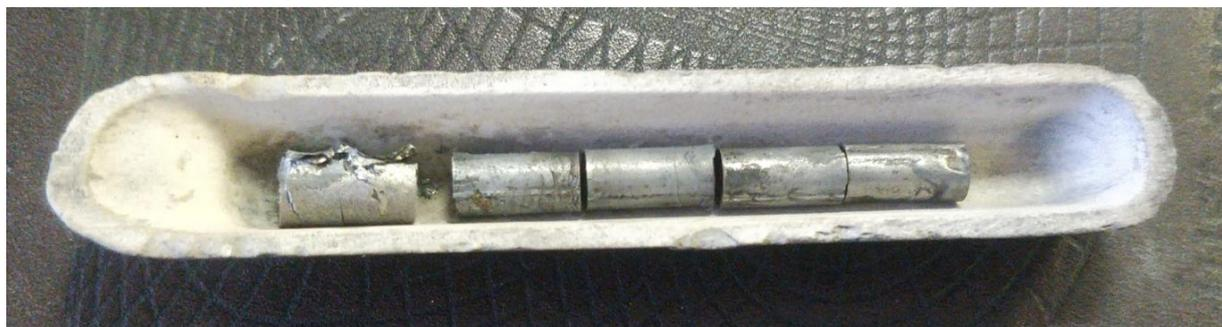
*Рисунок 15. Образцы сплава  $LaFe_xSi_{1.4}$  после гидрирования.*
