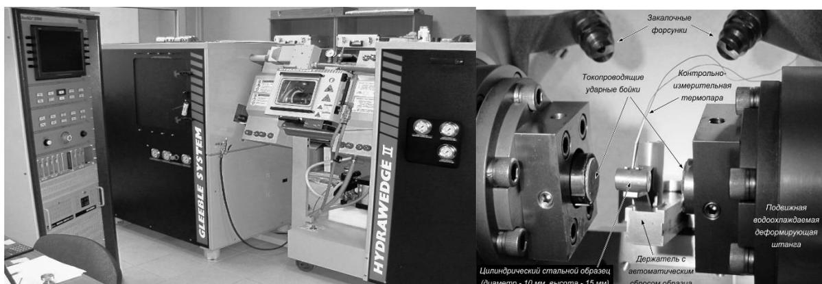
Рисунок 18. Многофункциональный испытательный комплекс «Gleeble System 3800».
