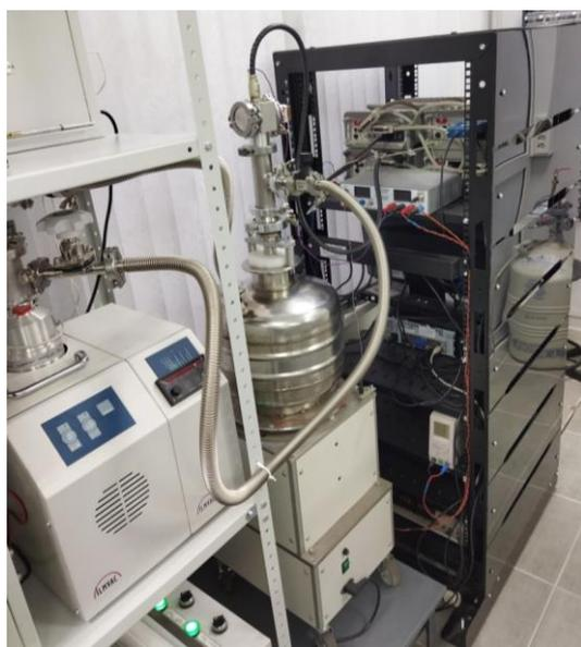
Рисунок 19. Установка прямого измерения МКЭ.
