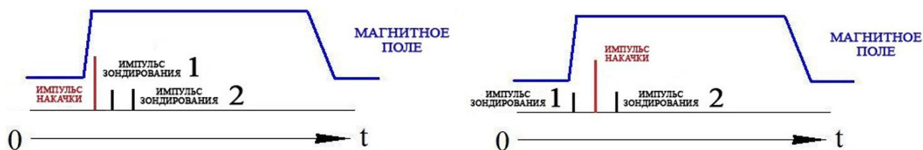
Рисунок 24. Взаимное расположение импульсов света и магнитного поля в двух геометриях: pump-probe1-probe2 и probe1-pump-probe2.
