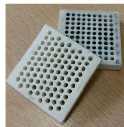
Рис. 17. Форма для изготовления столбчатых образцов
