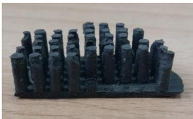
Рис. 18. Столбчатый образец с частицами железа 50%
