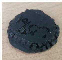
Рис. 19. Образец с чередованием концентрация 25% и 50% железных частиц
