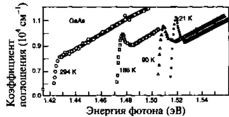
Рис. 8.3. Спектры поглощения в GaAs вблизи энергии, равной ширине щели, при различных температурах. Приведены экспериментальные точки и темные линии аппроксимирующих кривых.
