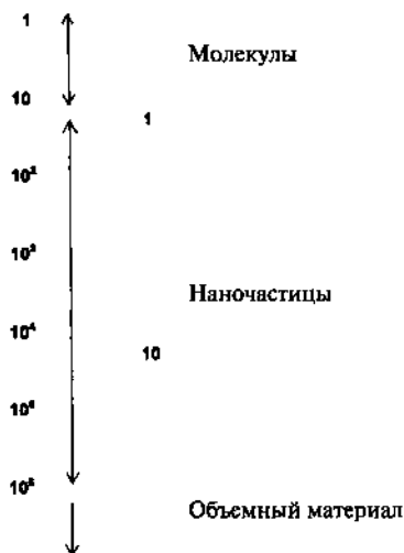
Рис. 4.1. Различие между неорганической молекулой, наночастицей и объемным телом на основе количества атомов в кластере.
