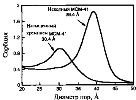
Рис. 10.8. Распределение диаметров пор в двух молекулярных ситах со средними диаметрами пор 3,04 и 3,94 нм, определенных методом адсорбции газобразного аргона.
