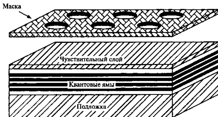
Рис. 9.5. Четырехслойная конструкция из квантовых ям на подложке, покрытая чувствительным слоем. Сверху показана маска для облучения при литографии.
