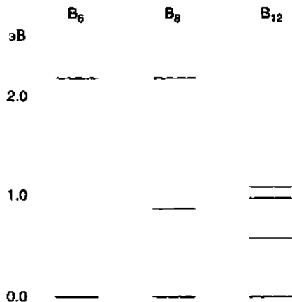
Рис. 4.10. Вычисления энергии возбужденных состояний наночастиц B_6 , B_8 и B_{12} по методу функционалов плотности. Индуцируемые светом переходы между нижним и вышележащими уровнями определяют цвет наночастицы.
