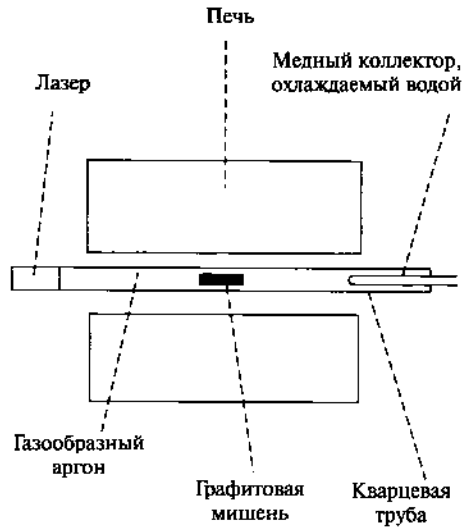
Рис. 5.12. Экспериментальная установка для синтеза углеродных нанотрубок лазерным испарением.
