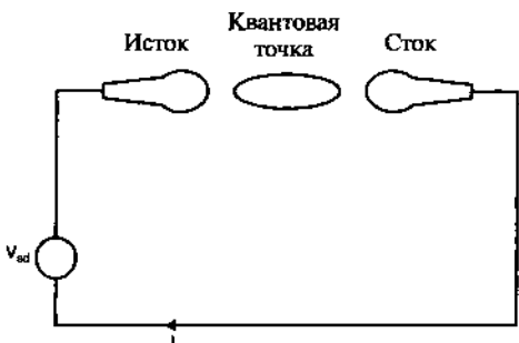
Рис. 9.16. Квантовая точка, подключенная к внешней цепи с помощью двух электродов — истока и стока.
