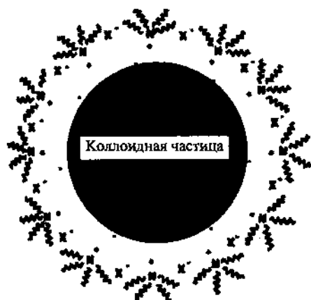
Рис. 10.22. Металлическая коллоидная частица, стабилизированная молекулами галлида тетраалкиламмония NR_4X .
