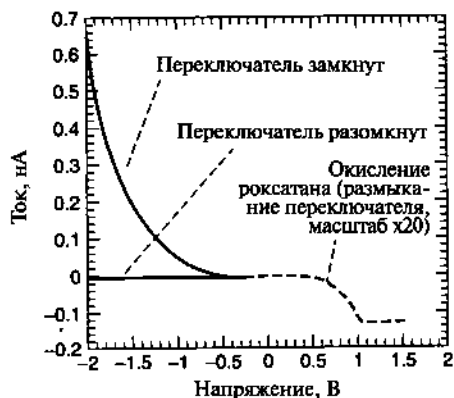
Рис. 13.22. Вольтамперные характеристики молекулярного переключателя, изображенного на рис. 13.21.
