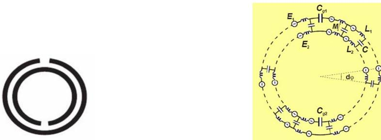
**Рис.32.** Схематичное изображение двойного расщепленного кольца (слева) и эквивалентная схема в ГГц диапазоне (справа)
