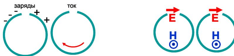
**Рис.33.** Распределение зарядов и токов в элементе метаматериала в случае высоких частот, когда длина волны сравнима с размерами элементов (слева), схематичное изображение результирующих магнитного и электрического диполей (справа).
