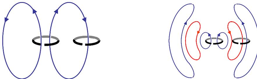
**Рис.30.** Схематическое изображение взаимодействия магнитных диполей (расщепленных металлических колец) в квазистатическом случае (слева) и с учетом запаздывания (справа), когда размеры диполя сопоставимы с длиной волны излучения.
