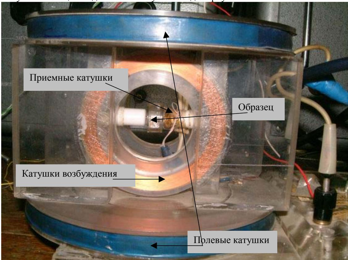
Рисунок 4. Общий вид системы катушек. Вид сбоку.
